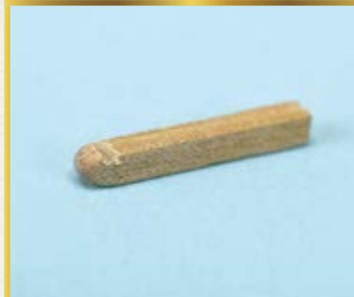
**6** С помощью круглого надфиля проточите паз чуть ниже округлого конца планки (на всех четырех ее сторонах), затем обработайте ее верхнюю часть наждачной бумагой. Таким образом вы изготовили стойку одного из релингов.
