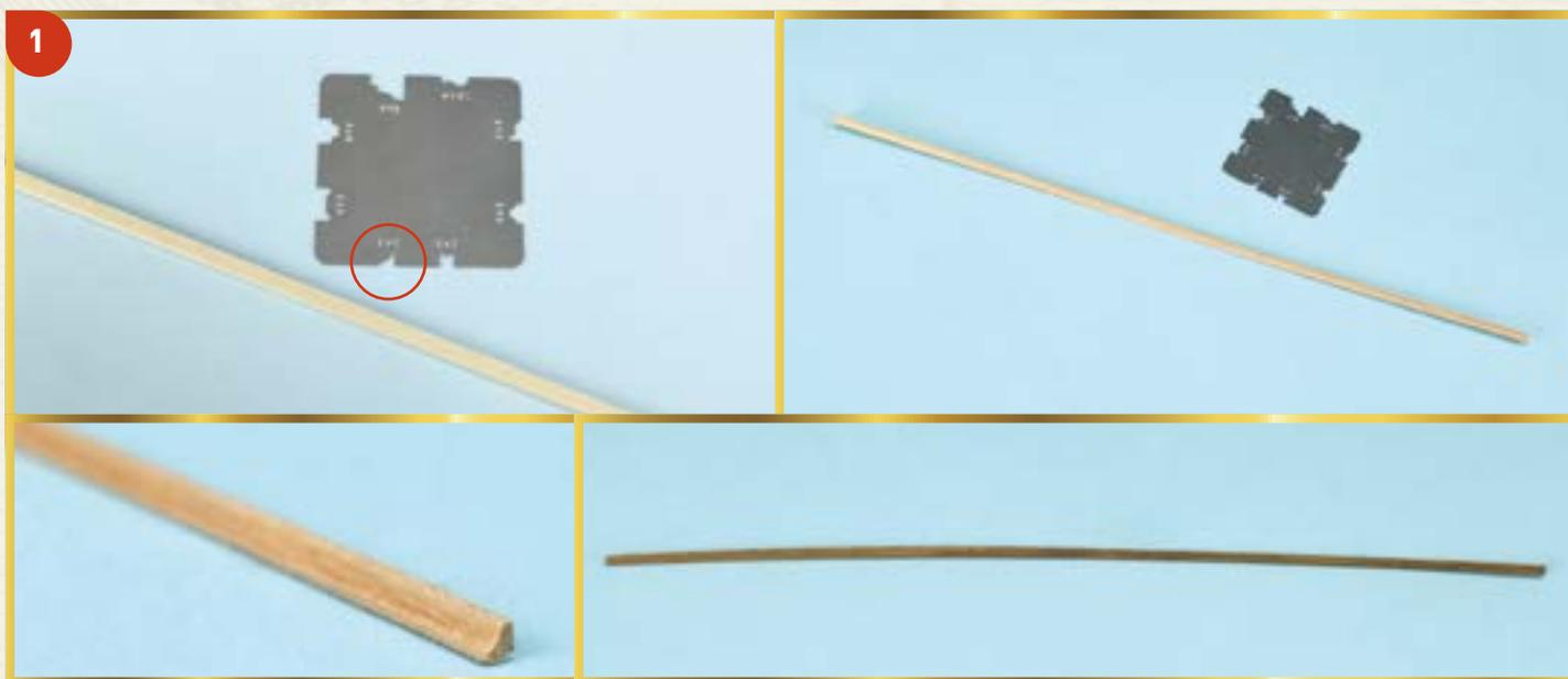
**1** В данном выпуске мы займемся двумя оставшимися релингами нашей модели. Однако сначала мы придадим необходимый профиль двум планкам 2 x 2 x 200 мм, которые прилагаются к этому выпуску. Обрежьте данные планки по размеру (см. шаг 2), а затем обработайте их одним из профилей (на фотографии отмечен красным кружком) шейпера — инструмента для профилирования планок. Обработайте обрезанные планки мелкозернистой наждачной бумагой и покройте морилкой цвета «орех».
